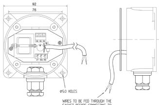
WIRES TO BE FED THROUGH THE GASKET BEFORE CONNECTING TO THE TERMINAL BLOCK.
